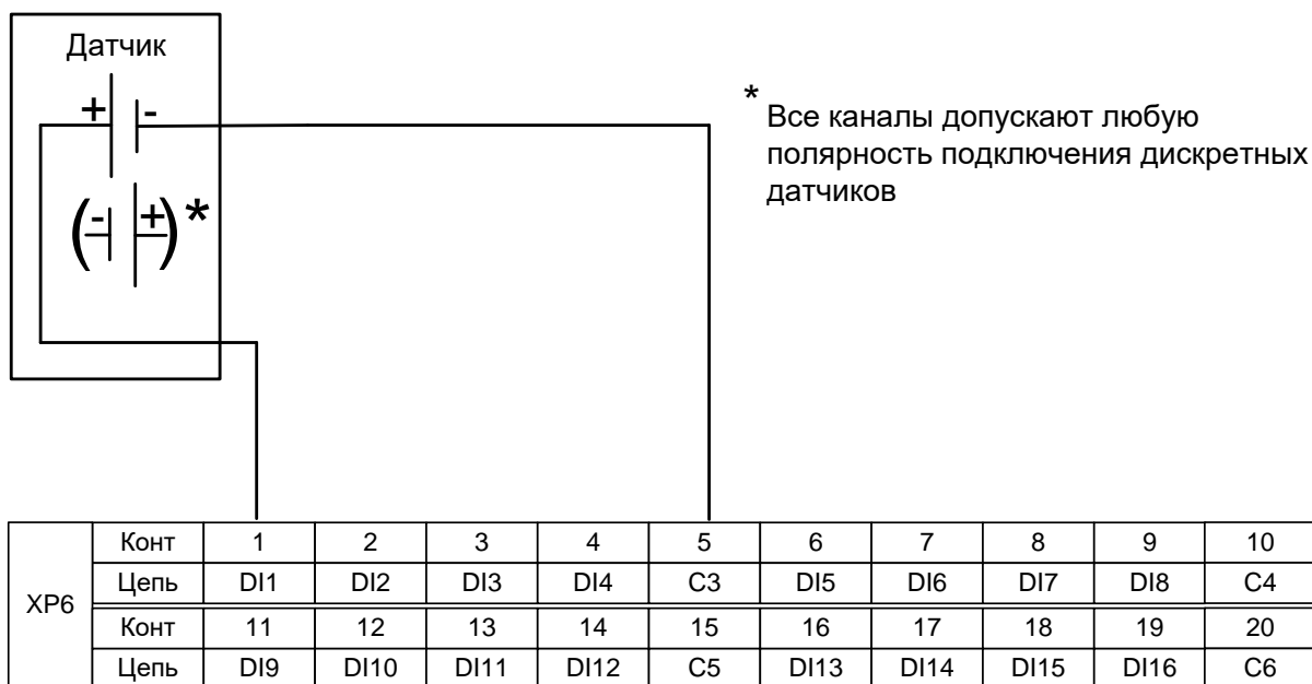
Рис. 1.3 – Подключение датчика к дискретному входу изделия
