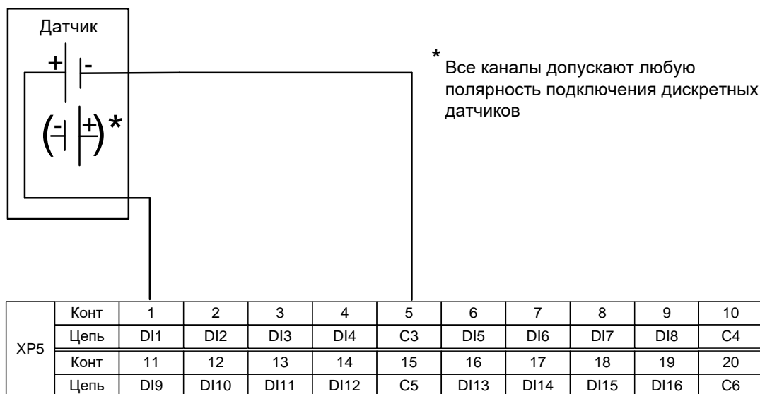
Рис. 2.3 – Подключение датчика к дискретному входу изделия
