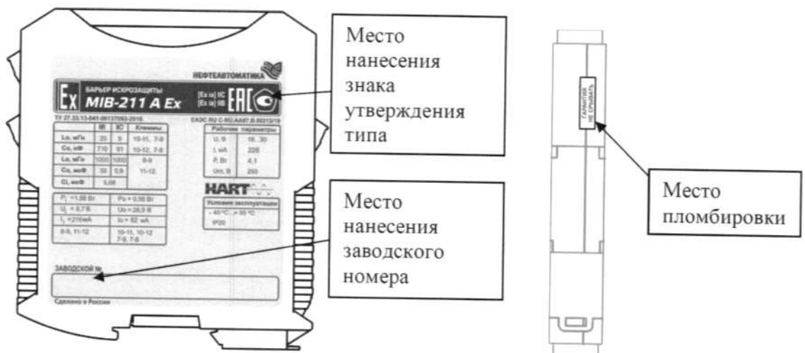
Рисунок 11 – Места нанесения знака утверждения типа, заводского номера и пломбировки
