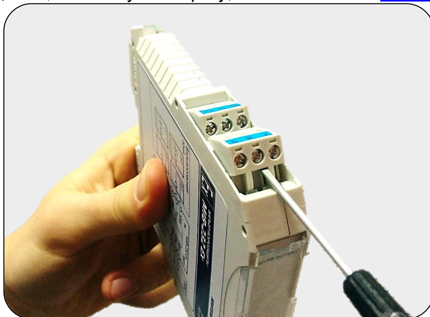
Рис. 2 – Отсоединение клеммной колодки
