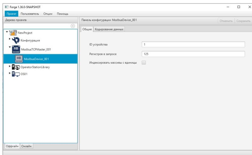
Рисунок 11. Устройство Modbus в дереве проекта
