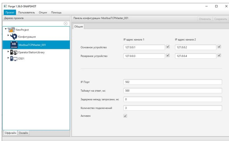
Рисунок 2. Modbus TCP Master в дереве проекта
