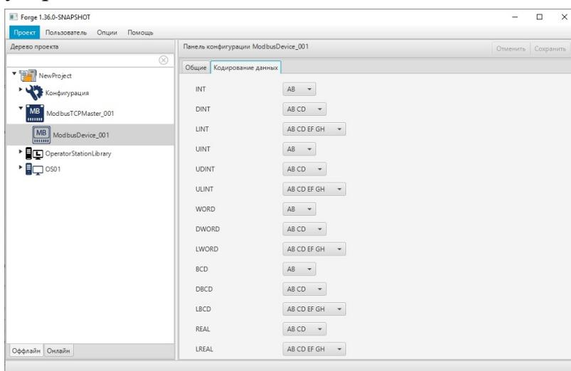
Рисунок 20. Вкладка "Кодирование данных" устройства Modbus
