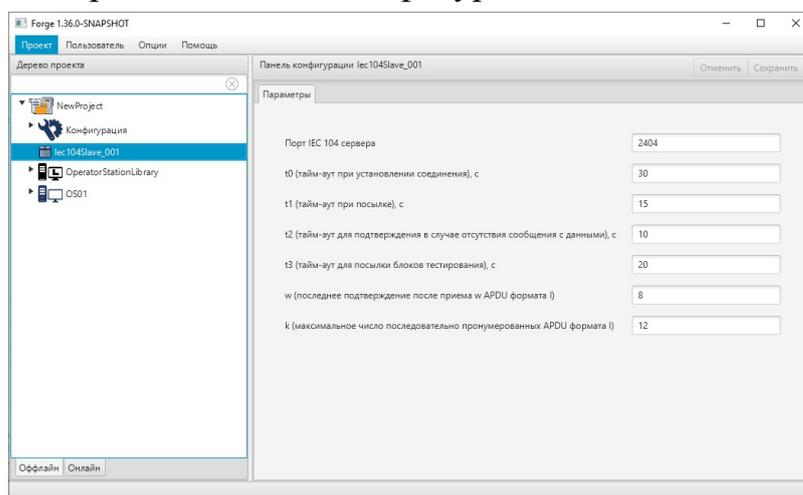
Рисунок 14. Настройка IEC 104 Slave. Вкладка "Параметры"
