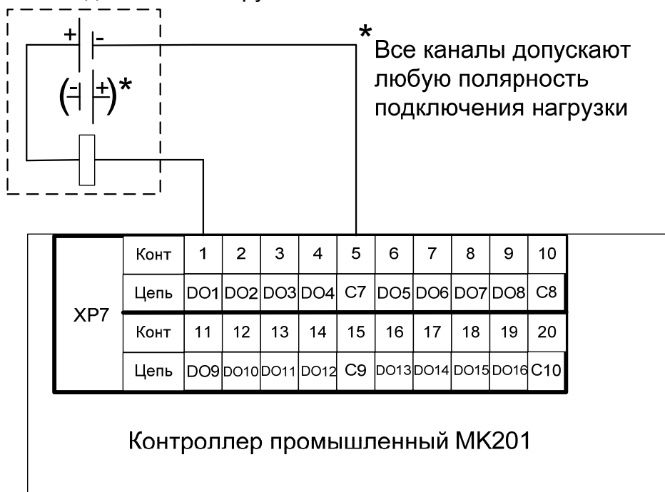
Рисунок 16 – Схема подключения нагрузки к одному из дискретных выходов контроллера промышленного МК201
