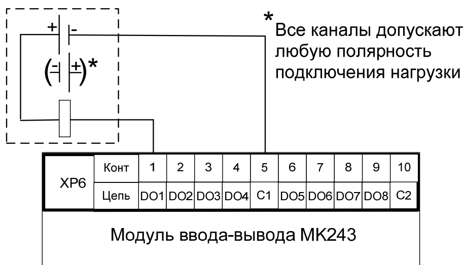
Рисунок 18 – Схема подключения нагрузки к одному из дискретных выходов модуля ввода-вывода МК243
