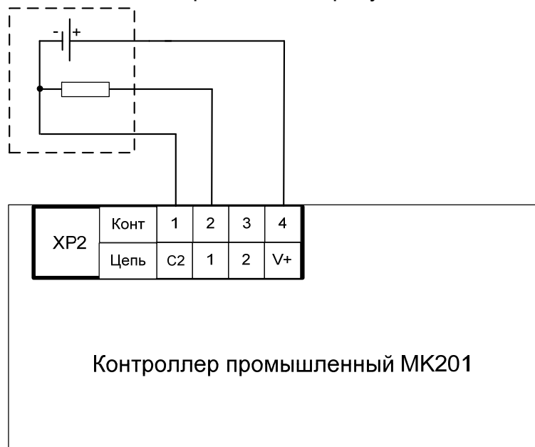
Рисунок 19 – Схема подключения нагрузки к одному из аналоговых выходов контроллера промышленного МК201
