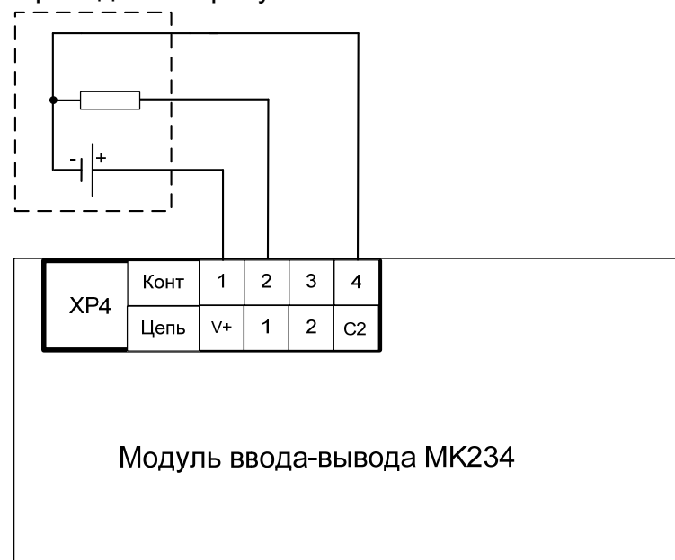
Рисунок 20 – Схема подключения нагрузки к одному из аналоговых выходов модуля ввода-вывода МК234
