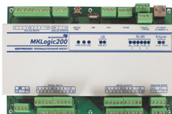
Рис.2. Контроллер серии MKLogic200.
