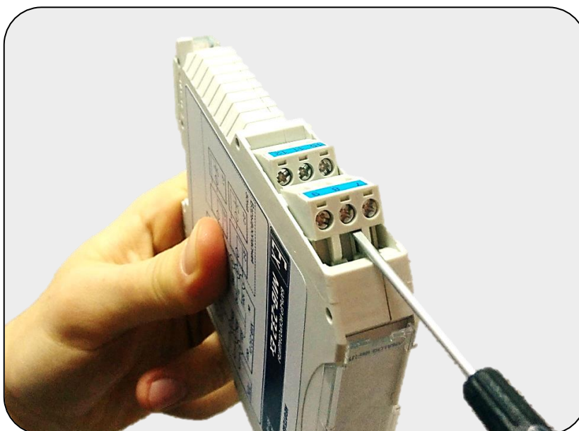
Рис. 2 – Отсоединение клеммной колодки
