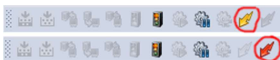
Рисунок 41 – Кнопки «Start System Events» (сверху) и «Stop System Events» (снизу) панели инструментов «Target Execution»
