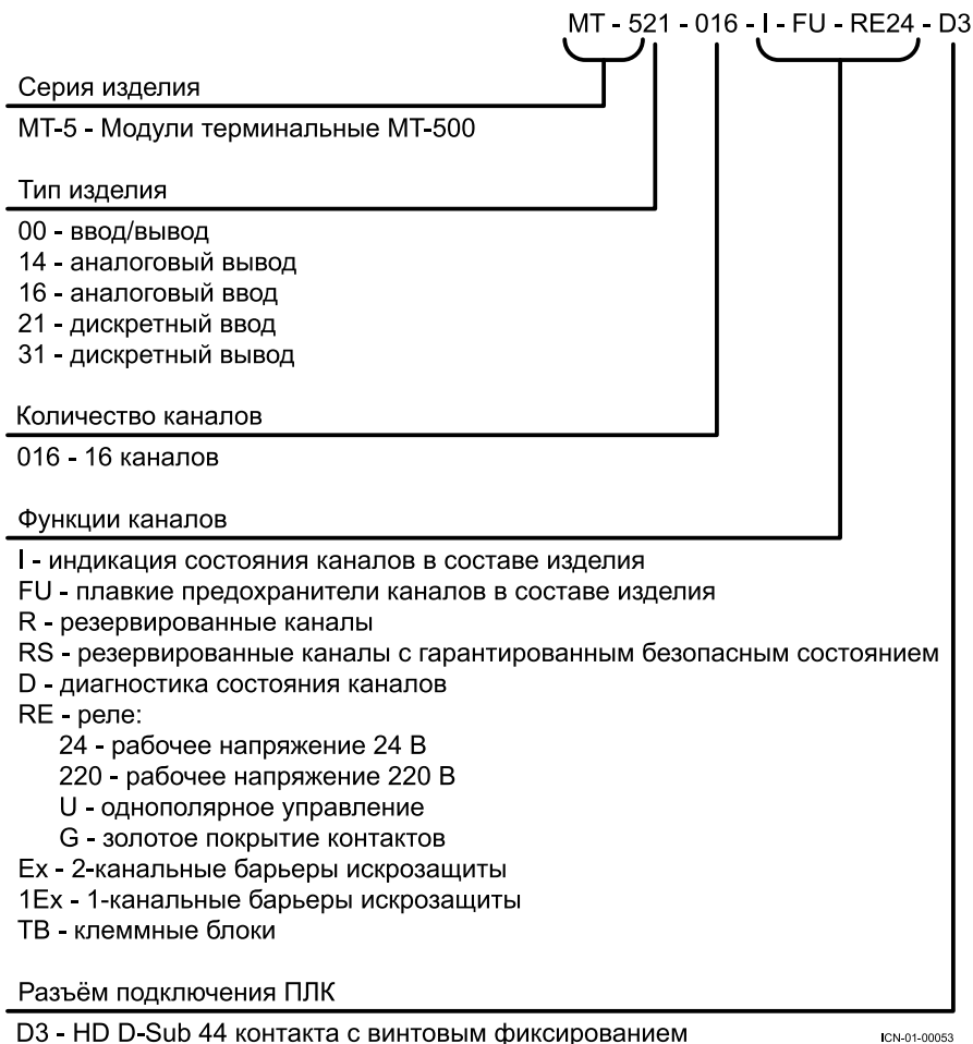
Рис. 1.1 – Расшифровка обозначения модулей МТ-500
